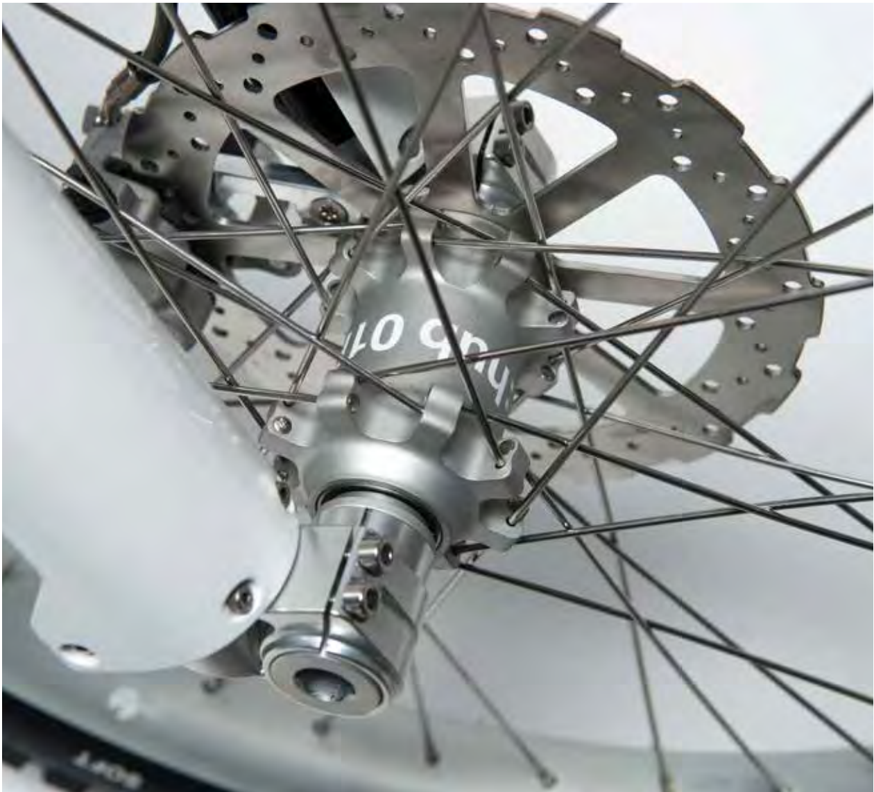
Framnav tillverkat med en rad tekniker främst skärande bearbetning.
