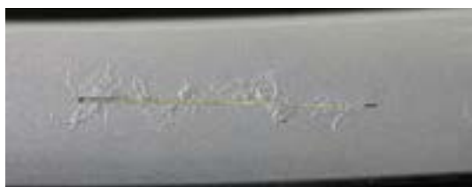
Fig 7.8 Filiformkorrosion vid rits på en lackerad aluminiumdetalj efter ACT-provning (Accelerated Corrosion Test).
