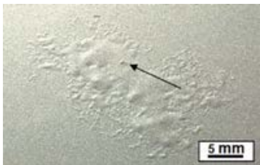
Fig 7.7 Filiformkorrosionsattack på aluminiumdel från ett fordon. Pilen visar defekter i färgskiktet där korrosionen startat.
