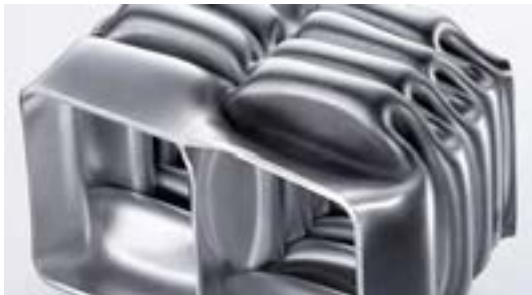
Fig 13.6 Stål har generellt sett större deformationspotential än aluminium. Därför har de flesta aluminiumföretag utvecklat "krocklegeringar" för att på bästa sätt kunna ta upp krockenergin. Aluminium tar upp krockenergin så bra att materialet i en speciell dubbelhåprofil kan veckas ihop vid en krock – utan att spricka – till vad som ser ut som ett ihoppressat dragspel. Deformationsförmågan är hög. Stål deformeras också, men det intressanta är energiupptagningen per viktnhet hos strukturen. Fler bilkonstruktörer vet nu att detta är ett område där aluminium ger mer för pengarna.
