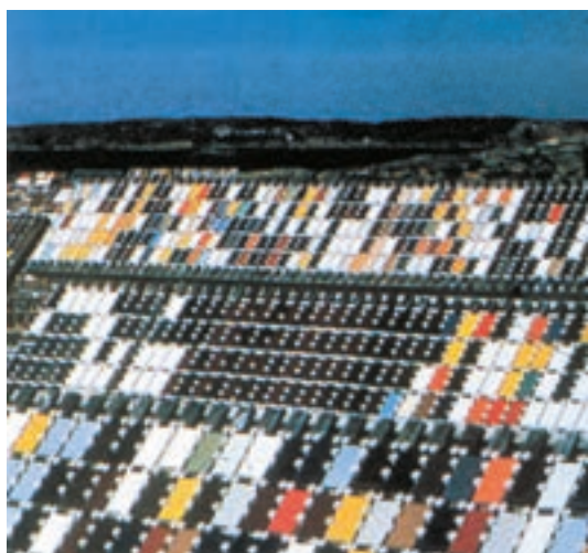
Fig 7.9 Korrosionsprovning i naturlig miljö på västkusten.
