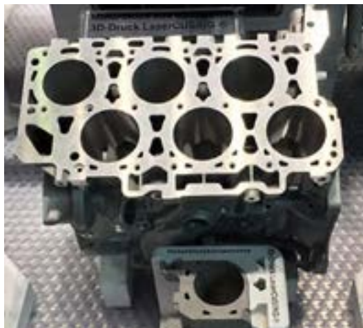
Fig 9.11 Motorblock printat av Robert Hoffmann GmbH, i aluminium till en VW. (foto Sten Farre)
