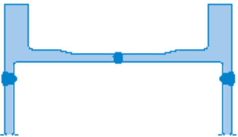
Fig 12.12 Likadan gejder tillverkad av aluminiumprofiler. Antalet svetsar är 3.
