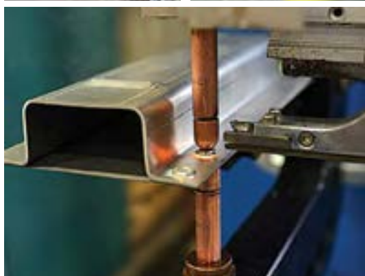
Fig 11.15 RSR-teknologin använder en kombination av punktsvetsning och självstansande nitar för fogning av olika material, t.ex stål mot aluminium. Som fästelement används ett häftstiftsliknande stålelement som trycks genom ett hål i aluminiumplåten och punktsvetsas fast mot stålunderlaget.
