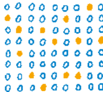
Fig 4.9 Atomanordning i en fast lösning.
