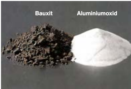
Fig 2.1 Bauxit förädlas till aluminiumoxid.
