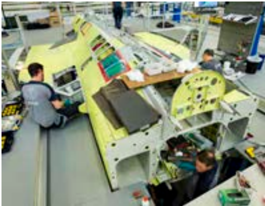
Fig 11.24 I ett flygplan finns många limmade aluminiumkomponenter. Gul färg är en primer, ofta använd inom flygindustrin.
