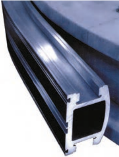
Fig 10.3 Dragbockning av aluminiumprofil.
