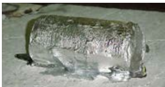
Fig 9.6 Halvfast ämne (semi-solid) för tixogjutning efter uppvärmning i ugn. Kutsen hänger fortfarande ihop efter uppvärmningen till 610°C.
