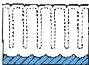
Fig 8.3 Eftertätat anodiserings-skikt med slutna porer.
