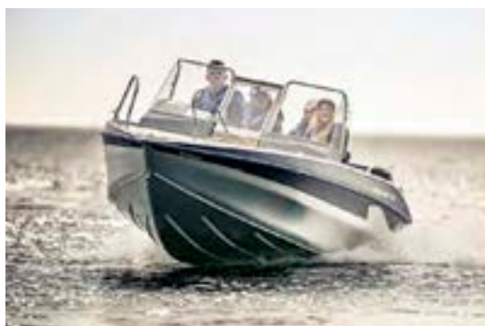
Fig 7.10 Snabbgående motorbåtar byggs i stor utsträckning av aluminium och används på grund av sin goda förmåga att tåla saltvatten.
