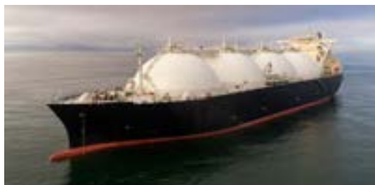
Fig 12.14 Sfäriska svetsade aluminiumbehållare används i fartyg för transport av flytande naturgaser (LNG) vid -163^{\circ}\text{C} eller kallare.
