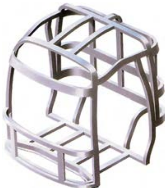
Fig 12.15 Lastbilshytt av aluminiumprofiler enligt det sk space-frame konceptet.
