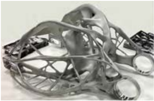
Fig 9.10 Årets gjutgods vid en stor gjuterikonferens i USA 2018. Ämnet skrevs ut i en sandform med binder jet-teknik (BJ) och sedan användes lågtrycksgjutning för att fylla formen.
