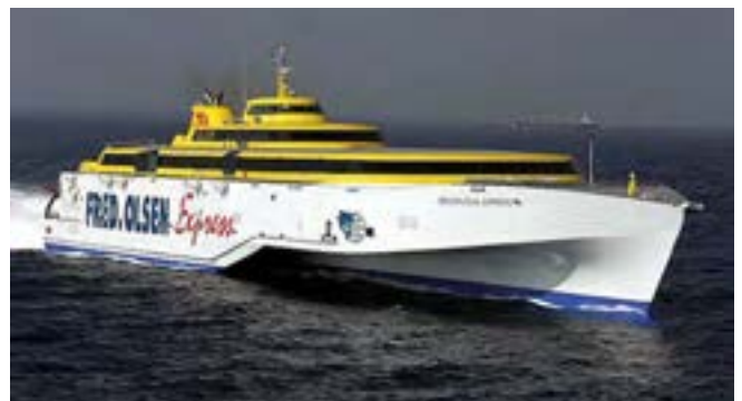
Fig 1.4 Benchijigua Express, byggd av Austal Ships, sjösatt 2004, är världens största aluminiumskepp. Dimensioner. 126,7·30,4·4,2 m.
