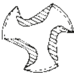
Fig 10.15 Jämförelse mellan ett gängverktyg för aluminium (ljus yta) och ett för stål (streckad).
